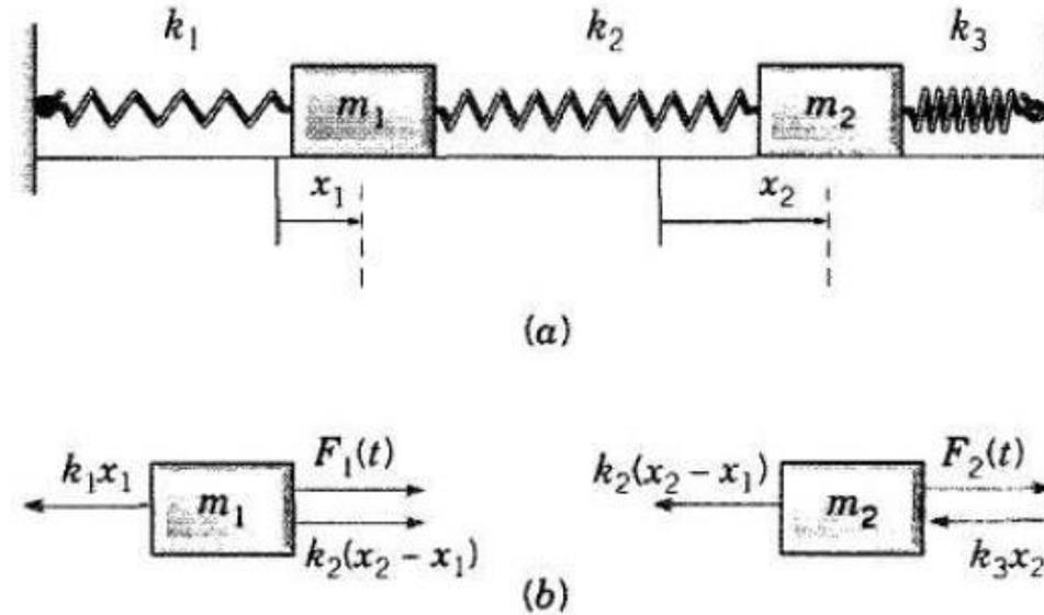
**FIG. 7.1.3** (a) Os deslocamentos  $x_1$  e  $x_2$  são ambos positivos. (b) O diagrama de forças para o sistema massa-mola.
