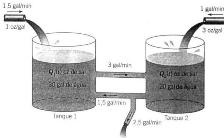
FIGURA 7.1.6 Dois tanques interligados (Problema 22).
